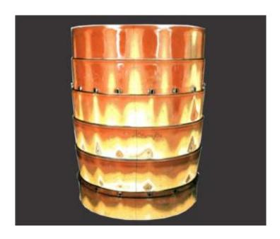
Термоиндикаторные краски позволяют производить анализ наибольших воздействующих температур и температурных переходов на вращающихся и неподвижных объектах, в том числе в реактивном двигателе.
